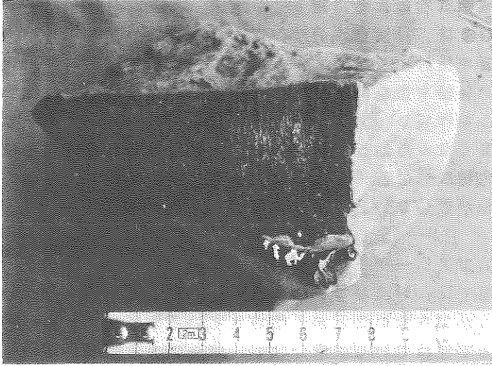
写真-4 レーザーによる切断面
